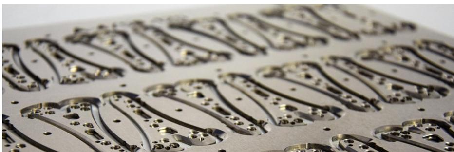
Durch Verändern der folgenden Parameter ist es möglich, unterschiedliche Konturen, Formen und Oberflächenrauhigkeiten zu erzeugen: Material der Bürste, Bürstendichte, Bürstendrehzahl, Tischdrehzahl, Arbeitsdruck, Arbeitszeit und Poliermittel
